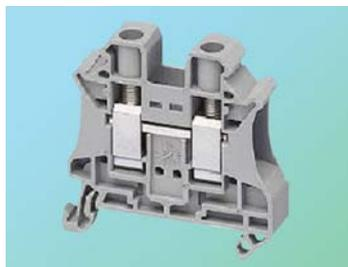
и эксплуатации электроустановок. Этому способствует обширный диапазон типоразмеров (в ассортименте клеммы для номинального тока 24, 32, 41, 57, 76, 125, 150 А) и сечений присоединяемых проводов (2 с половинной, 4, 6, 10, 16, 35, 50 мм<sup>2</sup>). Ширина клемм — от 5,2 мм до 20 мм. Причём, клеммы одного размера имеют три разновидности — обычная выкрашена в серый цвет, BL — в синий, PE — в жёлто-зелёный.
