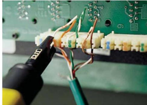
пружинный механизм для крепления кабеля с настройкой силы закрепляющего импульса, байонетный механизм крепления лезвий, антишоковая (противоударная) подушечка из неопрена.
