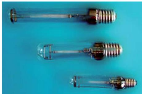
ром колбы — бездрессельные, роль балласта в них играет встроенная вольфрамовая нить (спираль). Они включаются напрямую в сеть 220 В с использованием цоколя E27/E40 — поэтому служат непосредственной заменой лампам накаливания в уличном освещении.
