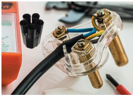
Перчатка Туп используется в кабельных муфтах для герметизации и изоляции корня разделки кабеля, она надежно герметизирует кабель от попадания влаги и других веществ и восстанавливает изоляцию кабеля в месте разделки.
