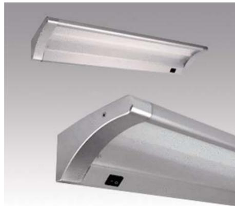
цоколем G5—13 или 21 Вт (C2791, C2792), с выключателем. Благодаря встроенному электронному ПРА зажигаются мгновенно и работают без мерцания. Корпус алюминиевый — но под серебро. От привычных линейных светильников отличаются несколько вогнутым профилем рассеивателя с призматической структурой. Рекомендуются для освещения торговых и жилых помещений, холлов и коридоров.
