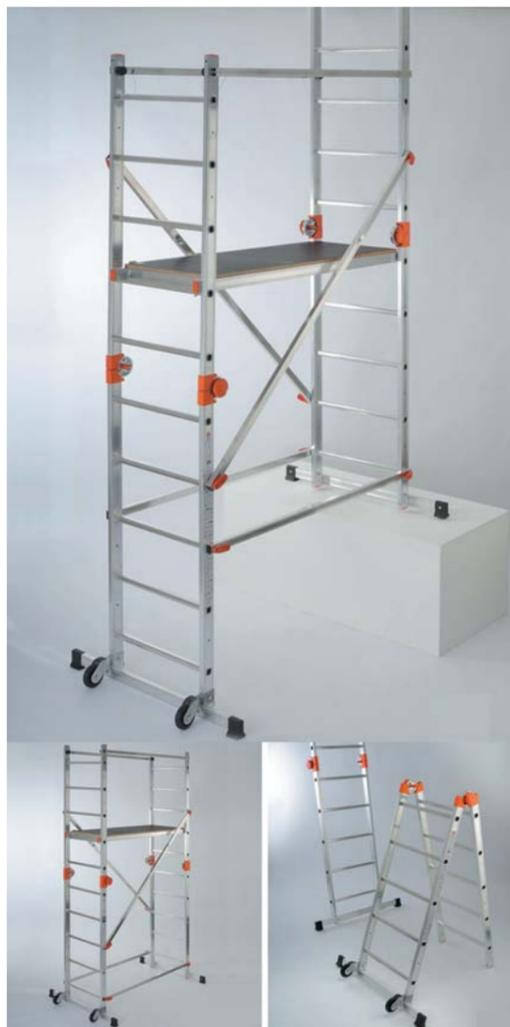
272 см, стремянка с двусторонним подъёмом до 135 см, на стойках можно двумя способами установить платформу и получатся подмости или рабочий стол. Кроме того, для устанавливания на наклонной плоскости или на лестничном марше можно собрать конструкцию типа платформы с разными высотами крепления рабочей площадки на стойках.
