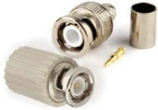
Терминаторы (H5513—H5518) TER-BNC-M-50 (или 75) предназначены для уменьшения помех при разводке высокочастотных сигналов, препятствуют отражению сигналов от места присоединения кабеля, поглощают блуждающие сигналы. По принципу действия — высокочастотная заглушка, для 50- или 75-омного (это важно) кабеля, которая надевается на разъём, когда он не скоммутирован. У нас есть модели просто терминатор, терминатор с колпачком (CAP в наименовании) и с цепочкой-заземлением (CHAIN).
