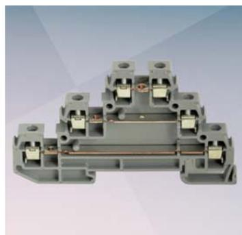
руются от 81,0 и 58,5 мм до 90,0 и 79,5 мм. Цветовая маркировка серого, чёрного и жёлто-зелёного цветов определяется исходя из назначения изделия. Величины номинального тока — 22 А и 32 А, номинального напряжения — 380 В, 50 Гц и 500 В, 50 Гц, сечения зажимов для проводов — 2,5 и 4,0 мм<sup>2</sup>. Из приятных «мелочей»
